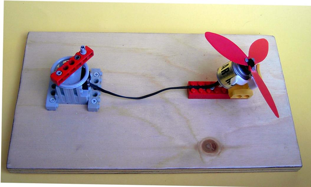
L'hélice tourne lorsqu'on actionne la manivelle.
